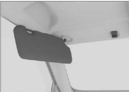
Чтобы перекрыть солнечный свет сбоку, опустите солнцезащитный козырек, отсоедините его и отверните в сторону.
