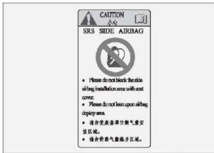
Данная наклейка расположена на центральной стойке кузова. Она служит напоминанием о том, что автомобиль оборудован боковыми подушками безопасности, и обращает внимание на связанные с этим опасности.
