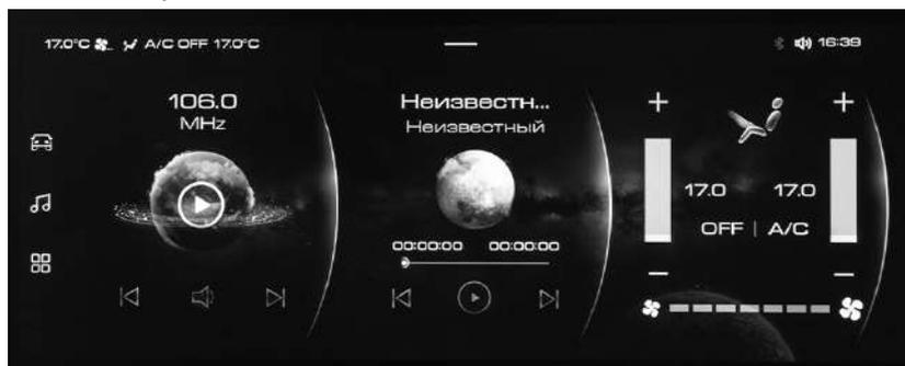
На главном экране отображаются окна различных приложений с функциональными кнопками, данными о состоянии и прочей информацией. Для переключения между окнами смахивайте экран влево или вправо.
