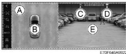
Автомобиль, оснащенный полностью автоматической интегрированной парковочной системой:
