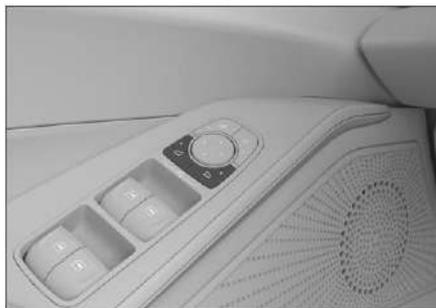
Нажмите две кнопки выбора наружных зеркал заднего вида одновременно. Наружные зеркала заднего вида автоматически сложаются. Нажмите еще раз, и наружные зеркала заднего вида развернутся автоматически.
