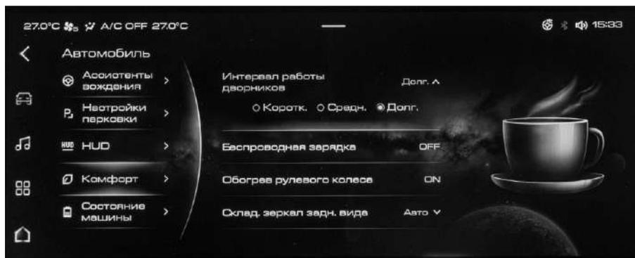
Коснитесь кнопки **【Время работы переднего стеклоочистителя】** для настройки интервала времени с момента включения насоса омывателя ветрового стекла до момента начала работы переднего стеклоочистителя.
